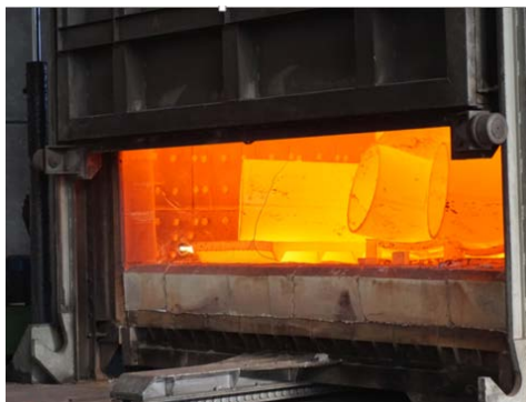
Figure 1 : Chauffage du composant à sa température d'austénitisation pendant un certain temps
