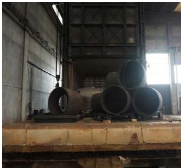
Figure 5 : Refroidissement à l'air
